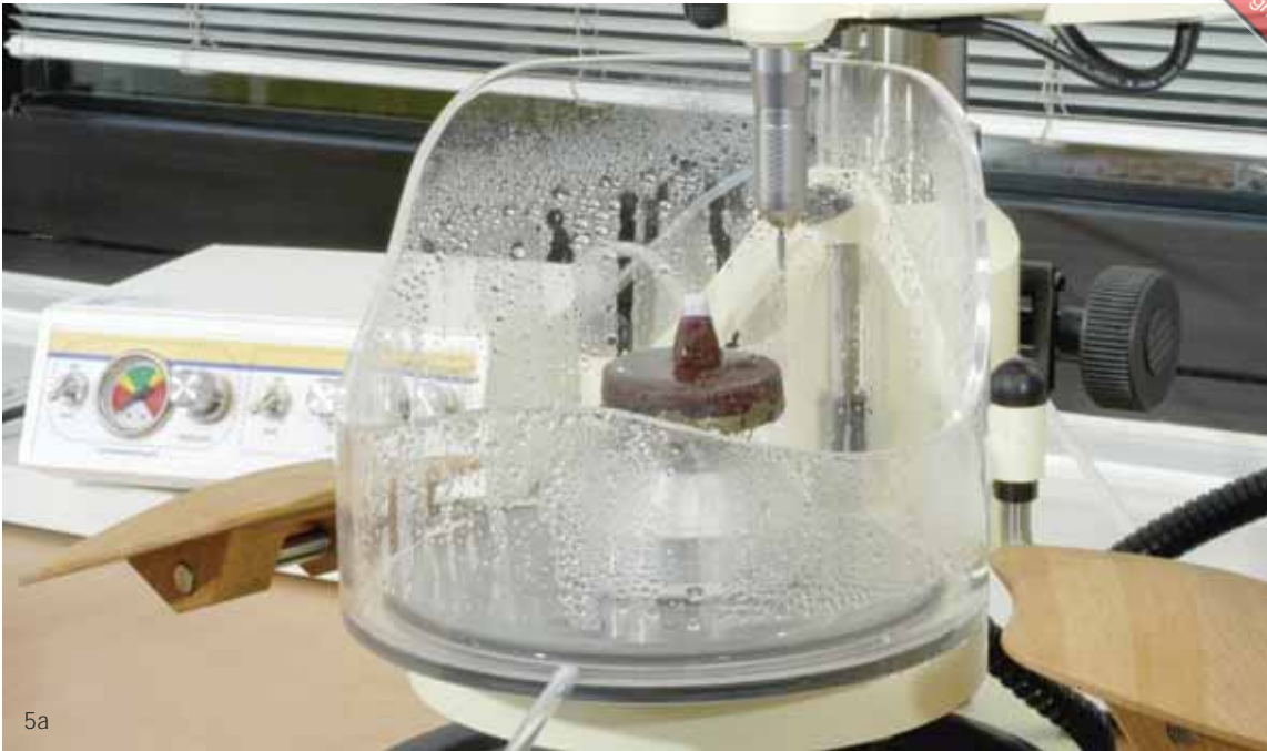
Abb. 5a Turbine und Steuergerät mit drehzahlunabhängiger Wasserkühlung
